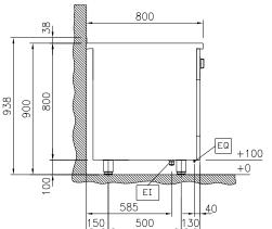
Electrical inlet (power) ΕI EQ Equipolential screw
